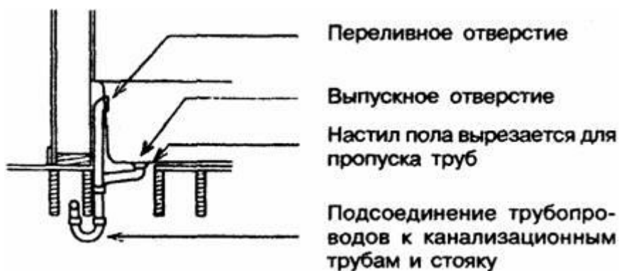
Рисунок — Детали установки умывальника и ванны
