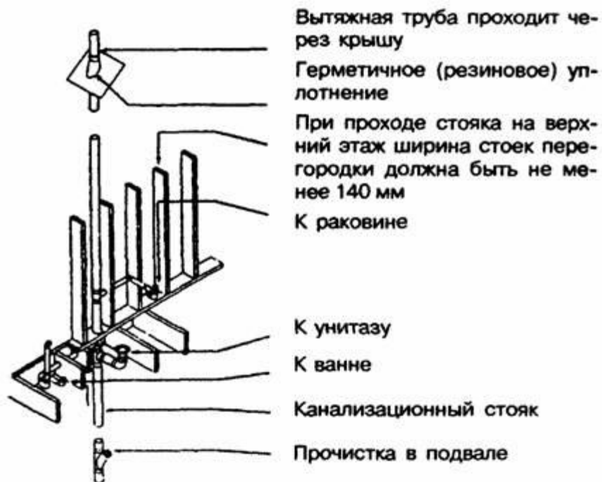
Рисунок — Прокладка канализационных труб в каркасе здания
